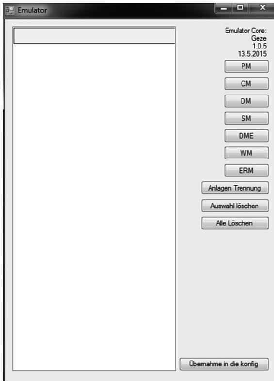
Avec l'émulateur, il est possible d'imiter une structure d'installation si le PC n'est pas connecté avec une centrale MBZ 300. Afin d'imiter la structure de l'installation, les différents modules sont ajoutés à une liste dans l'ordre décroissant. La fonction glisser-déposer permet de déplacer les modules dans la liste. La structure de l'installation établie de cette façon est ensuite chargée dans le programme de configuration, où les réglages peuvent être effectués.
