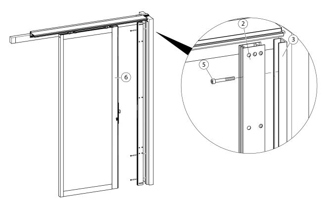
Fixer le profilé de baguette latérale (2) avec des vis (5) à travers la baguette murale (3) sur le mur.
