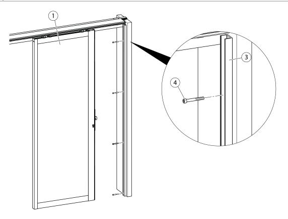
Monter la baguette murale (3) avec des vis (4) sur le mur et la placer en-dessous le cas échéant.
