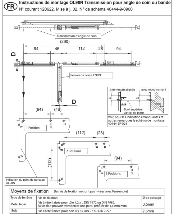
Vis à tête fraisée pour tôle 4,2 x L DIN 7972 ou DIN 7982
