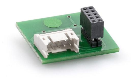
Platine d'interface enfichable pour le montage en série d'un maximum de deux détecteurs GC 363 SF combinés à surveillance automatique
