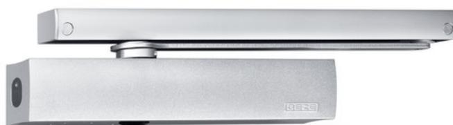
Ferme-porte en applique avec bras à coulisse pour portes à un vantail avec une largeur de vantail jusqu'à 1 400 mm, avec fonction débrayable électrique
