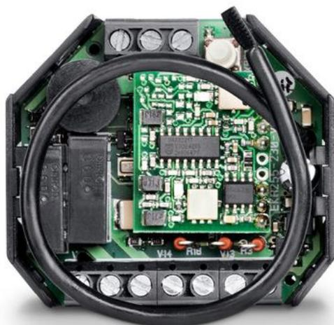
Module récepteur pour la commande des motorisations de
