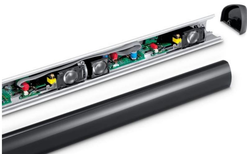
Sensor de sécurité avec des normes de sécurité élevées pour sécuriser les portes battantes et les portes tournantes automatiques
