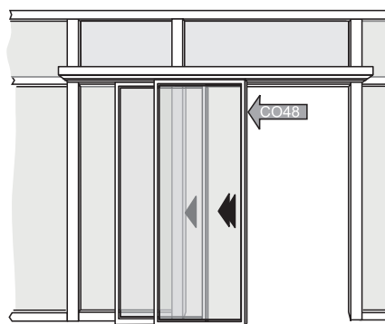
Vue de l'intérieur, situation de fuite version SLT-CO48, fermant à droite
