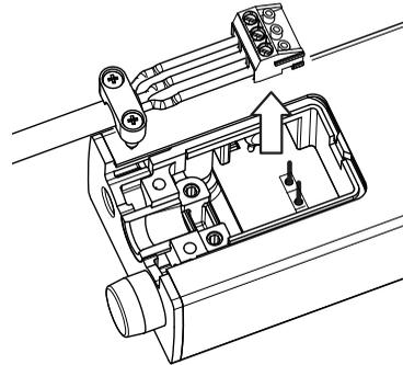
3. 断开电缆与插头的连接，使用接线套筒连接新的连接电缆。
