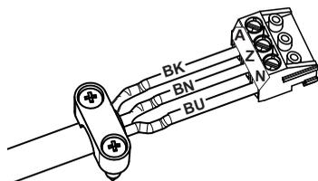
4. Brancher la prise avec le nouveau câble et monter la décharge de traction.
