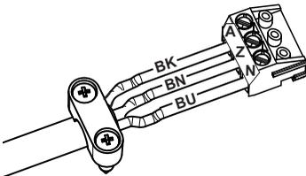
4. Stecker mit neuem Kabel einstecken und Zugentlastung montieren.
