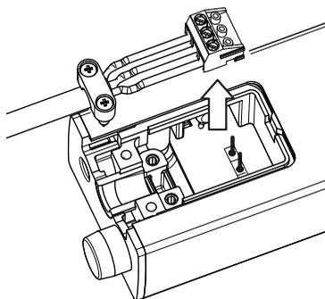
3 Desconecte el cable de la clavija y conecte una nueva conexión de cable. Emplee para ello terminales de cable.
