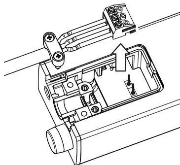
3. Отсоединить кабель от штекера и подсоединить новый соединительный провод, при этом использовать гильзы для оконцевания жил.
