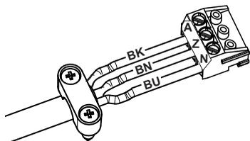
4 Conecte la clavija con el nuevo cable y monte la descarga de tracción.
