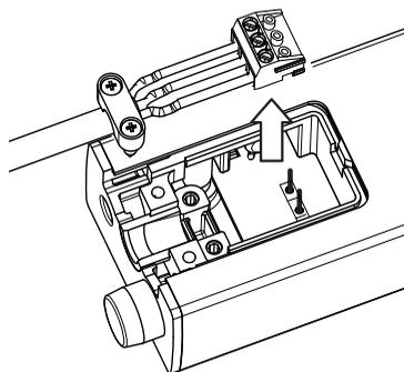
3. Débrancher le câble de la prise et brancher le nouveau câble, en utilisant des cosse de câbles.
